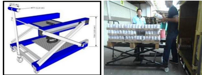
Gambar 2.2. Desain dan Uji Fungsi Alat Scissor Lift Ergonomis (Siska, dan Saputra, 2014)
