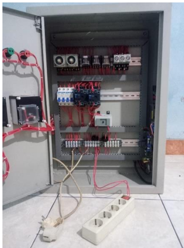
F. Gambar Rangkaian ATS-AMF
