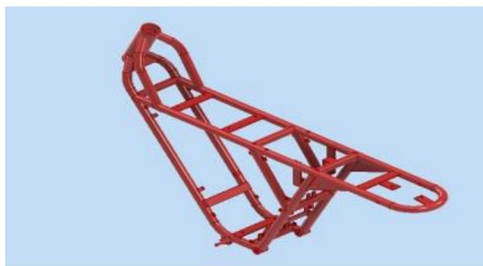
**Gambar 2.2** Rangka sepeda motor listrik
