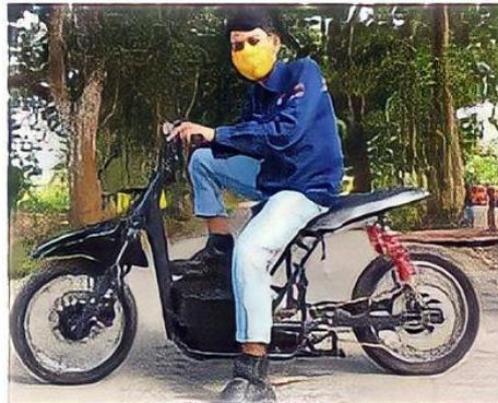
**Gambar 2.3** Hasil pembuatan sepeda listrik untuk beban 80 kg
