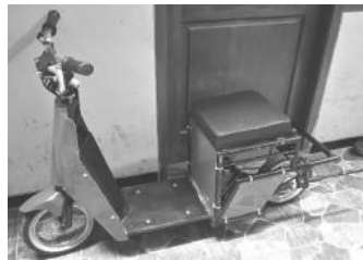
Gambar 2.2 Konstruksi sepeda motor listrik keseluruhan (Nurhadi dkk, 2018)
