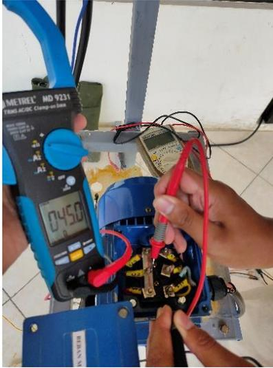
Proses pengukuran nilai resistansi pada setiap kumparan motor induksi. Kumparan yang di ukur yaitu kumparan U, V, dan W serta masing-masing kumparan juga di ukur antara kumparan U,V, dan W ke bagian Body atau Grounding.
