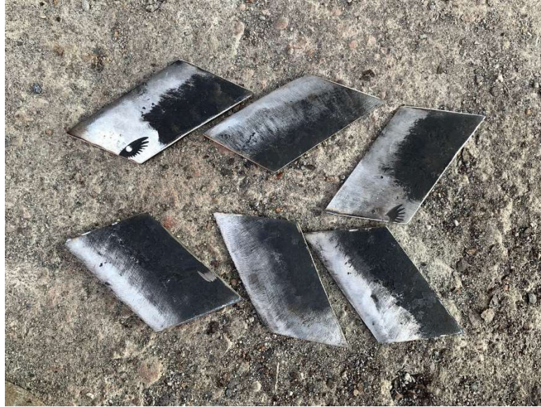
Gambar 6A Proses pemotongan mata pisau dengan sudut 55 derajat
