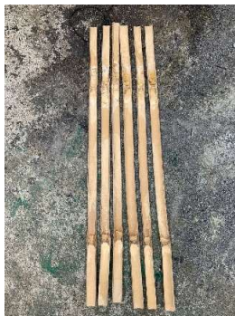
Gambar 8C Hasil pembelahan bambu diameter 64 mm
