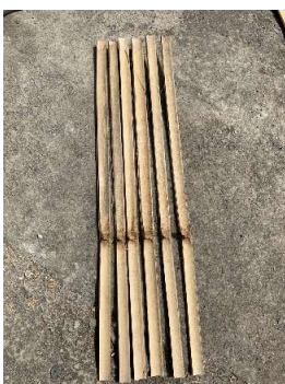
Gambar 8E Hasil pembelahan bambu diameter 68 mm
