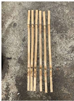
Gambar 8B Hasil pembelahan bambu diameter 62 mm
