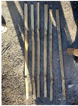
Gambar 8A Hasil pembelahan bambu diameter 60 mm
