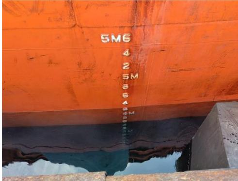
Gambar diatas merupakan angka draft yang diambil dari sisi kapal.
