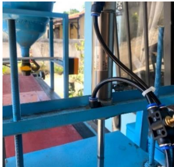
Gambar 2. 3 Silinder pneumatik II (Sumber: dokumen pribadi)
