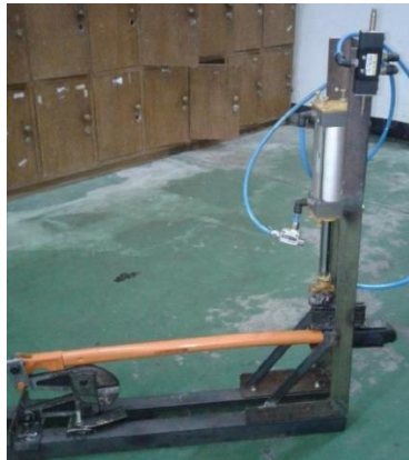
Gambar 2. 1 Hasil pembuatan alat pemotong kawat kedua dengan penambahan quick exhaust (Rusman dan Wijaya. 2021)
