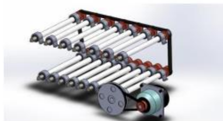
Gambar 2.1 Komponen transmisi penyortir kentang (Agil dan Sunaryo, 2022)
