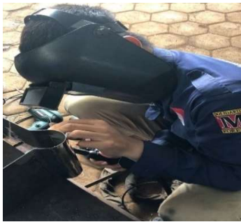
Gambar 5 Proses pengelasan hopper
