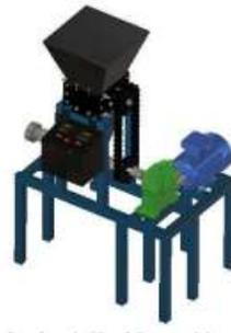
Gambar 2. 1 Mesin produksi pellet plastik (Purnomo, A., dkk. 2021)
