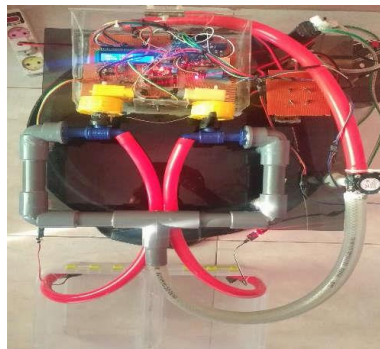
Gambar 2.1 alat pengukur debit air berbasis arduino (Yusuf dkk. 2019)
