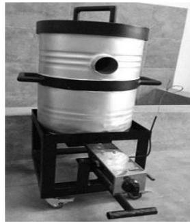
Gambar 2.2. *Prototipe* Tungku Krusibel Kompak Mini (Soemowidagdo, 2017)
