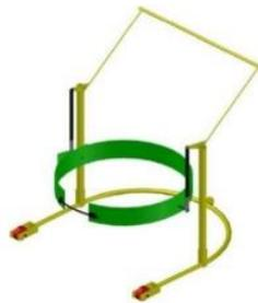
Gambar 2.3 Alat pemindah drum dengan sistem sudut putar (Orlando, 2020)
