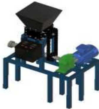
Gambar 2.1 Mesin produksi pellet plastik (Purnomo, dkk, 2021)
