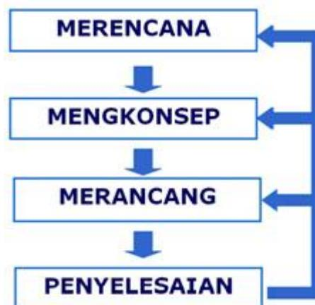
**Gambar 2.2** Diagram alir perancangan VDI 2222
