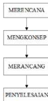
**Gambar 2.4** Metode Perancangan Menurut VDI 2222 (Pahl et al. 2007)
