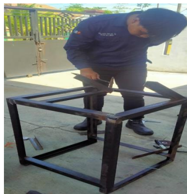
Gambar 3. Proses penghilangan kerak las
