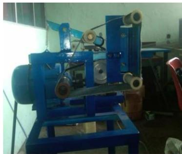
Gambar 2.2 Mesin amplas sistem sabuk (Rofarsyam, 2018)
