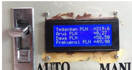
Pengujian Sumber Genset Beban lampu 60 W
