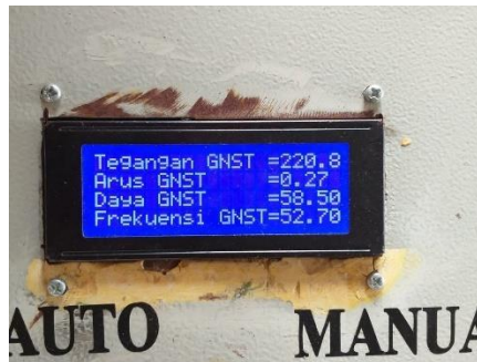
Pengujian Sumber Genset Beban lampu 60 W
