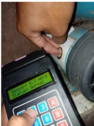
Gambar (d) Posisi Sensor Piezoelektrik Bagian Depan
