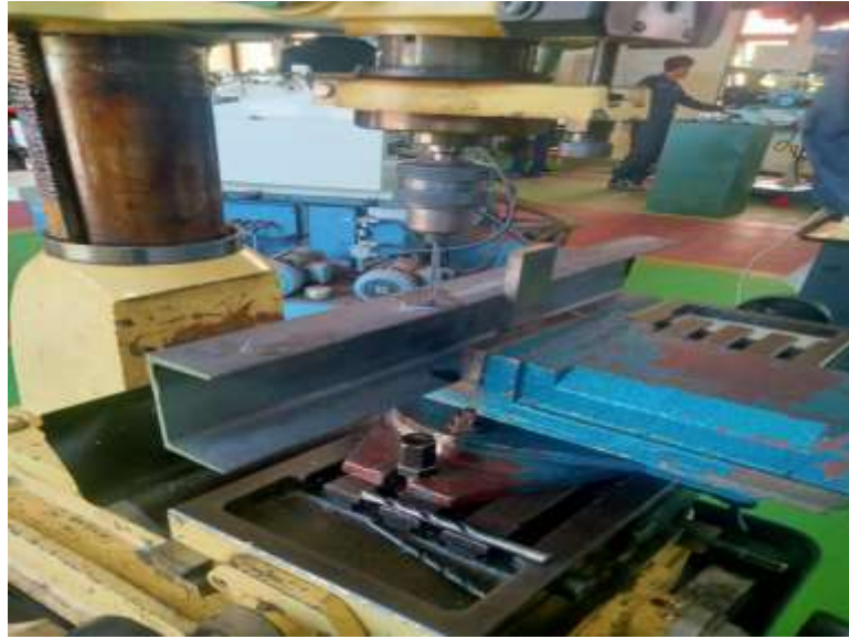
Gambar Proses pengeboran upper frame (Dokumentasi : Politeknik Negeri Cilacap, 2022)
