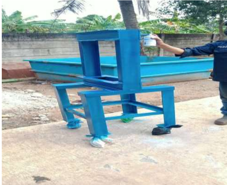
Gambar Proses cat rangka (Dokumentasi : Politeknik Negeri Cilacap, 2022)
