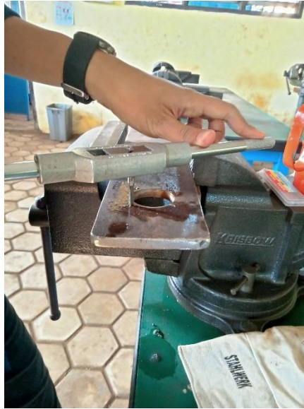
Gambar Proses Tap manual pada pelat penekan (Dokumentasi : Politeknik Negeri Cilacap, 2022)
