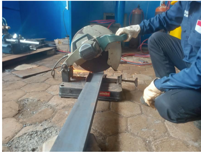
Gambar Proses Pemotongan besi UNP (Dokumentasi : Politeknik Negeri Cilacap, 2022)
