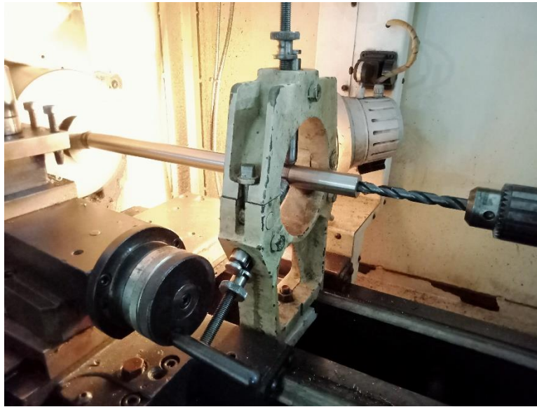
Gambar Proses Bubut Pengeboran pada poros sliding (Dokumentasi : Politeknik Negeri Cilacap, 2022)
