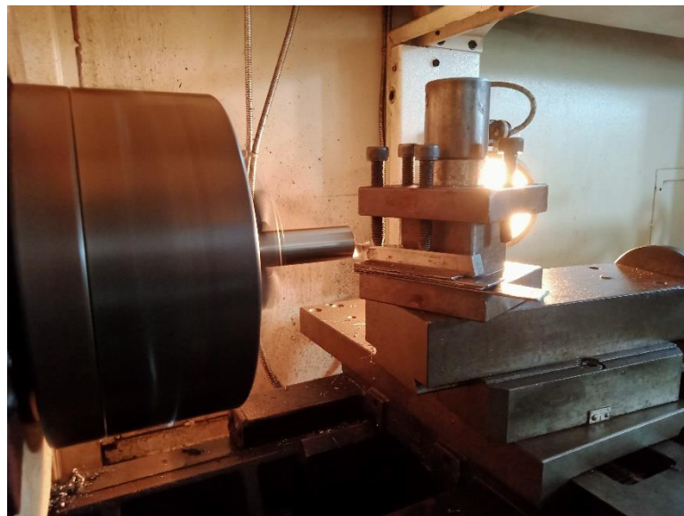
Gambar Proses Bubut facing pada poros sliding (Dokumentasi : Politeknik Negeri Cilacap, 2022)
