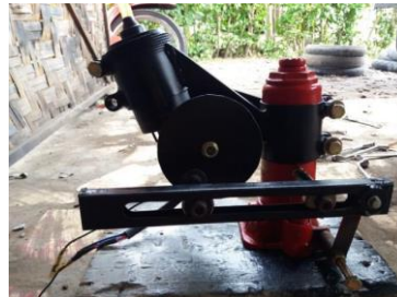
Gambar 2. 4 Desain hasil perancangan dongkrak hidrolik elektrik. ( Nurhasim, M., 2017)
