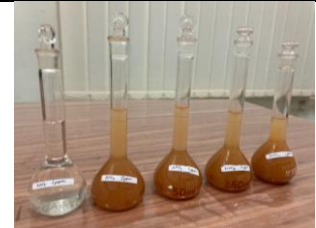
Preparasi sampel larutan standar dengan konsentrasi 1, 2, 3, 4, 5 ppm
