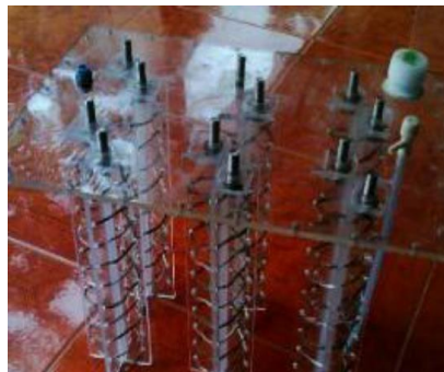
Gambar 2.6 Elektroda Berbentuk Spiral (Amin & Nurdiana, 2020)
