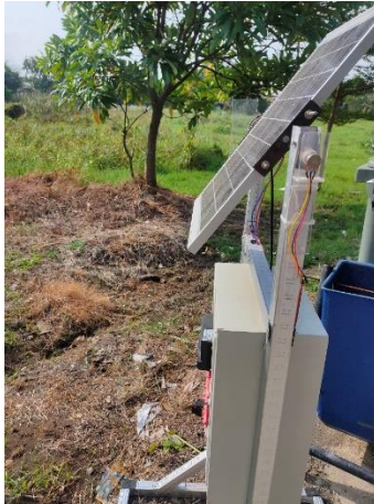
Posisi Panel Surya Pada Saat jam 15.00 WIB Menunjukkan Sudut Kemiringan 135^{\circ}
