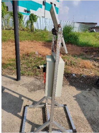
Posisi Panel Surya Pada Saat Jam 9.00 WIB Menunjukkan Sudut Kemiringan 45 0
