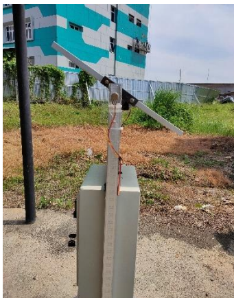
Posisi Panel Surya Pada Saat jam 11.00 WIB Menunjukkan Sudut Kemiringan 75^{\circ}
