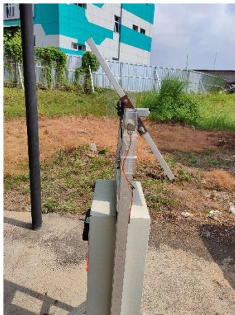
Posisi Panel Surya Pada Saat jam 10.00 WIB Menunjukkan Sudut Kemiringan 60 0
