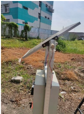
Posisi Panel Surya Pada Saat jam 14.00 WIB Menunjukkan Sudut Kemiringan 120^{\circ}
