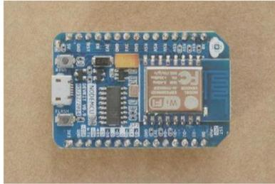
**Gambar 2.5 NodeMCU ESP8266** <sup>[17]</sup>
