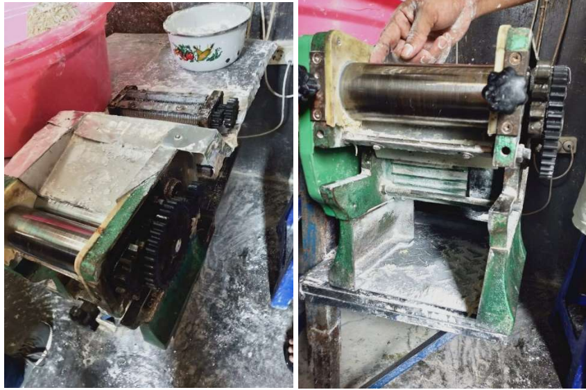
Gambar mesin pemipih dan pemotong adonan mie milik pembuat mie yang diwawancarai
