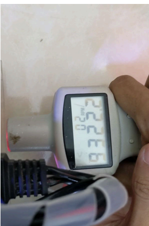
Gambar pengukuran Rpm dengan tacometer pada motor I
