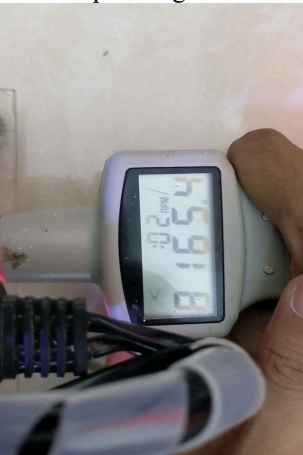
Gambar pengukuran Rpm dengan tacometer pada motor II
