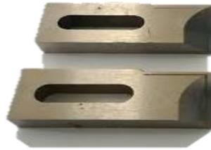
**Gambar 2. 4** Pisau serut mesin dowel
