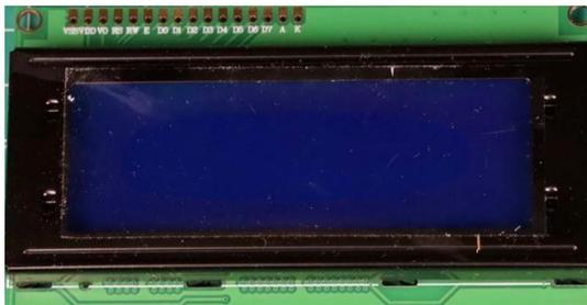
Gambar 2.11 LCD 20x4<sup>[23]</sup>.
