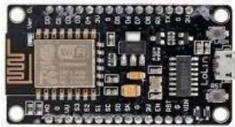
Gambar 2.1 *Node Mcu ESP 8266*<sup>[11]</sup>.Tabel 2.1 Spesifikasi *Node Mcu 8266*<sup>[11]</sup>.
