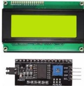
Gambar 2. 5 LCD 20X4 Dengan i2C
