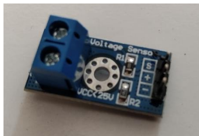
Gambar 2.4 Sensor Tegangan (Sumber: Dok. Pribadi, 2022)
