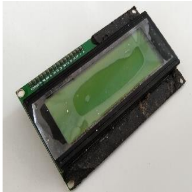
Gambar 2.7 Liquid Crystal Display (LCD) (Sumber: Dok. Pribadi, 2022)
