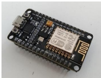
Gambar 2.2 NodeMCU ESP8266 (Sumber: Dok. Pribadi, 2022)
