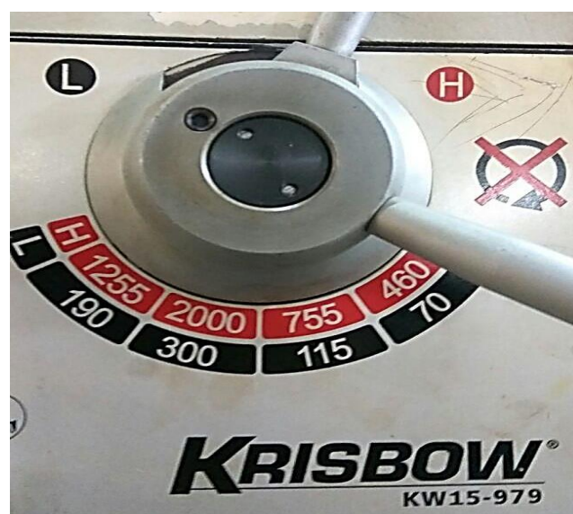
Gambar 2 Kecepatan spindle pada mesin bubut
