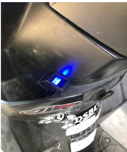
Gambar (d) Pemasangan sensor sidik jari pada sepeda motor
