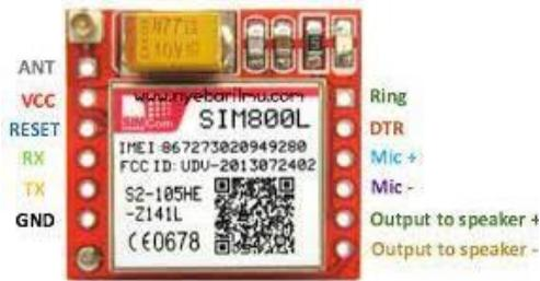
Gambar 2.3 Modul GSM SIM 800L<sup>[7]</sup>
