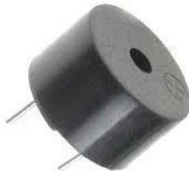
Gambar 2.8 Buzzer<sup>[12]</sup>
