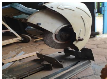
Gambar 2.7 Cutting Wheel(Dokumentasi pribadi)
