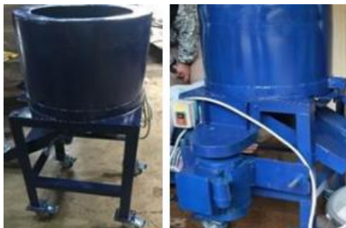
Gambar 2.1 Mesin pembersih dan pengupas kentang (Sugandi dkk, 2018)
