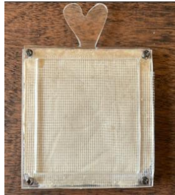
Tempat membran pada alat pereduksi CO
