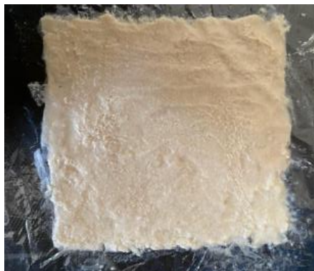
Pencetakan membran SA
