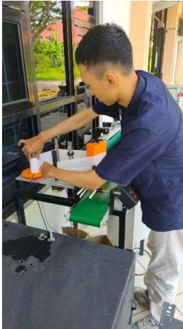
Gambar (f) Proses peletakan label
