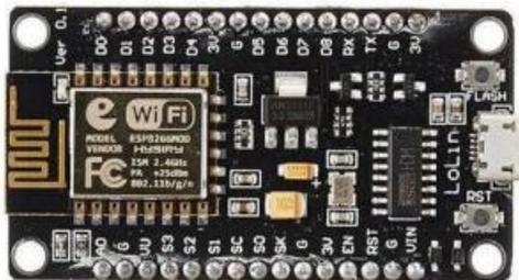
**Gambar 2. 4 NodeMCU ESP8266**
