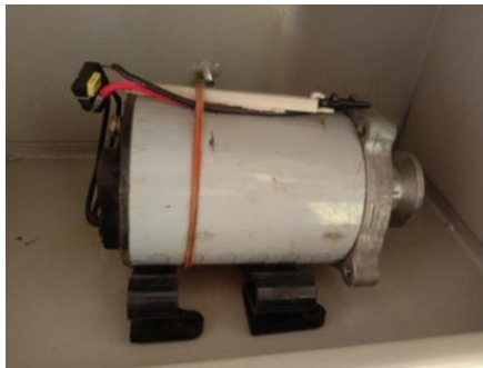
Gambar 2.3 Generator DC (Sumber:dok.pribadi, 2022)
