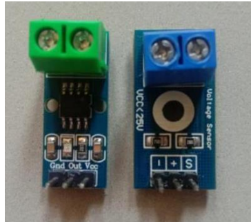
Gambar 2.7 Sensor Arus Tegangan (Sumber:dok.pribadi, 2022)
