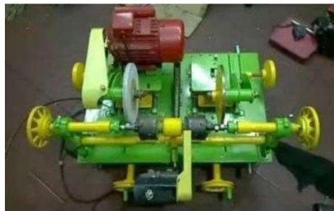
Gambar 2.1 Mesin Duplikat Poros Cam (Nasution et al., 2019)
