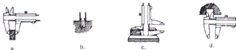
Gambar 2.24 Contoh penggunaan dari jangka sorong (Sumbodo, 2008)
