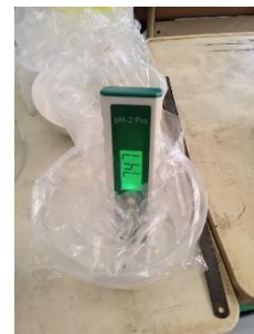
(d) Pengecekan nilai pH pada hasil penyaringan bahan cangkang telur teraktivasi HCl
