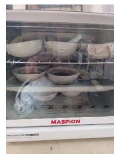
(b) Pengovenan bahan sebagai uji kadar air pada cangkang telur
