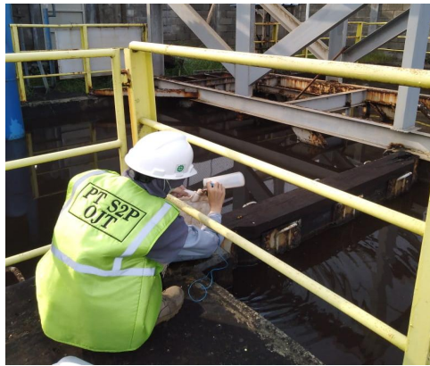
Pengambilan Sampel Inlet WWTP
