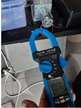
(Pengukuran Daya Listrik Motoran Penggerak Screw )
