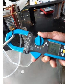
(Pengukuran Daya Listrik Modul Induksi)
