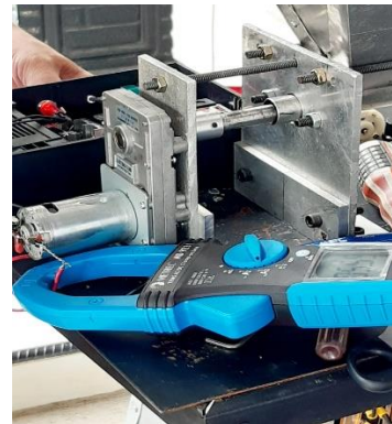
(Proses Pengecekan Arus Listrik)
