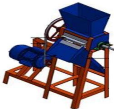
Gambar 2.3 Hasil rancangan desain mesin pengupas biji kopi basah menggunakan mesin motor listrik (Wiranata et al., 2021)
